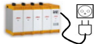
Voorbeeld: meerdere inverters koppelen en via de Steca gridcontrol (niet noodzakelijk, maar wel handig) aan het net voeren.
